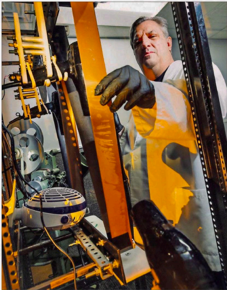
Kelly Pribble inspecciona una cinta en su máquina de rebobinado húmedo, durante el proceso de restauración de grabaciones deterioradas
